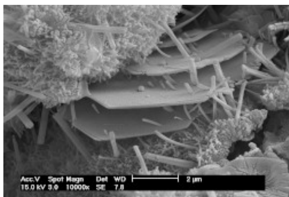
Hydratation d'un liant à base de ciment Portland dans un mortier de jointoiment traditionnel
